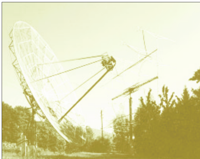
Bild 14: 8-m-Spiegel von HB9SV; als Erreger dienen ein zwischen 0° und 90° Polarisierung drehbarer Dipol für 70 cm sowie ein zirkular polarisiertes Horn für 23 cm. Im Hintergrund ist eine 16er-Gruppe aus 17-Element-Yagis für 2 m zu erkennen.
