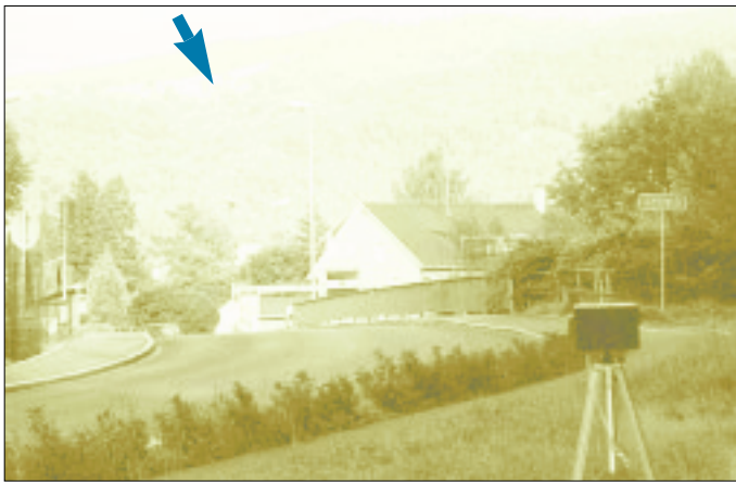
Bild 1: Standort von DA5FA/p in JO47UM89 bei einer Lichtsprechverbindung DL-OE mit OE9NAI/p im 214-THz-Band (bei f = 319 THz); der Pfeil markiert die Gegenstation. Für erste Experimente empfiehlt es sich jedoch, im Bereich des sichtbaren Lichtes (394-THz-Band) zu bleiben.
