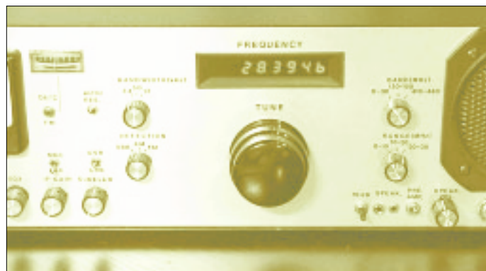
Bild 5: Mustertransceiver des Autors; in der Mitte sind Frequenzanzeige und Feintrieb zu erkennen.
