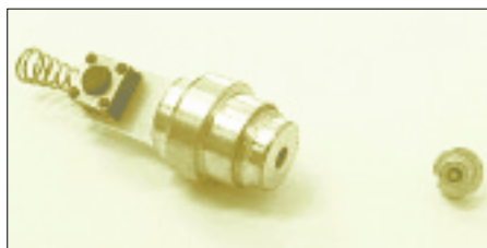
Bild 4: Laserdioden, rechts einzeln, links komplett als Modul mit Kollimator und Elektronik. Letztere muß ggf. auf kürzestem Weg mit der Diode verbunden sein!
